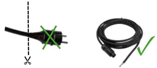
Das lose Ende des 3-adrigen-AC-Kabels wird mit dem im Lieferumfang enthaltenen AC-Stecker verbunden:
